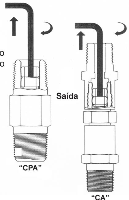
5. Verifique a pressão de abertura e ajuste os parafusos novamente, se necessário.
