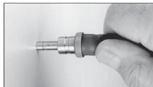
3. Apoie a conexão contra uma superfície plana. Segure a mangueira e empurre-a com força constante até que a mangueira assente na tampa de acabamento, de cor azul.
