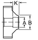
Solda Tipo Encaixe para Tubo Flexível (TSW)
